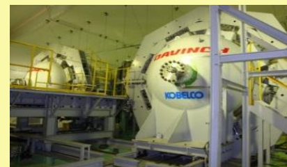
きい剤を抜き取った補給容器を爆破するための加工
