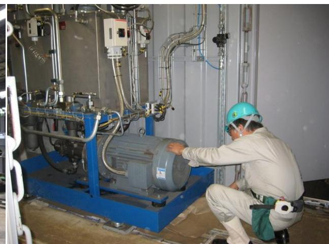
加熱爆破処理設備ユニット化作動試験中
