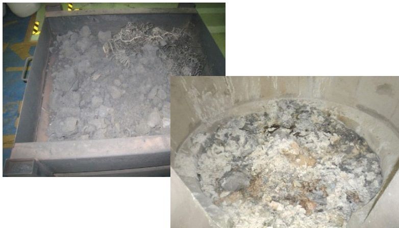
燃焼処理された砲弾残渣、焼却灰
