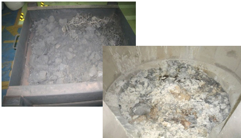
燃焼処理された砲弾残渣、焼却灰
