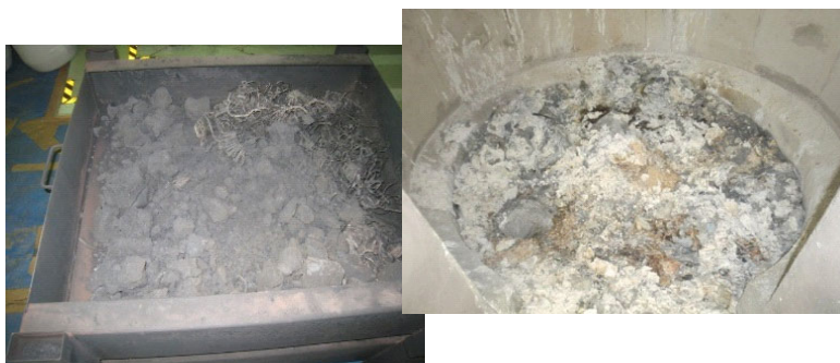
燃焼処理された砲弾残渣、焼却灰
