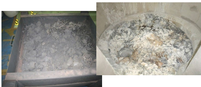
燃焼処理された砲弾残渣、焼却灰
