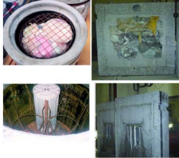
図 8-21 放射性廃棄物種別「F3-2-05」のコンディショニングに関する説明 出所) ANDRA、放射性廃棄物種別インベントリ、2019 年 3 月
